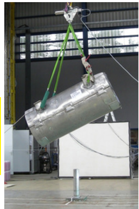
Essai de chute sur poinçon d'une maquette d'emballage DN30 de Daher-NCS
